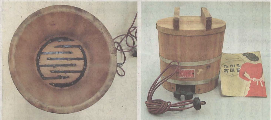
「たからおはち」の外観(右)と内部の電極板(左)。1947年実用新案登録。県歴史文化博物館蔵
